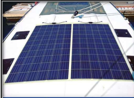
Yelkenli / Güverte Üzeri Montajı
